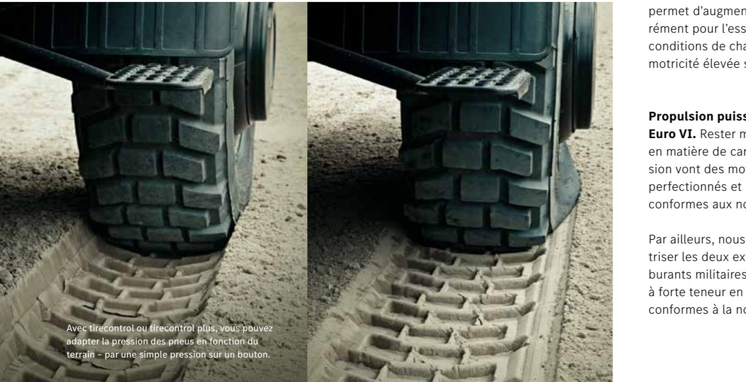
Avec tirecontrol ou tirecontrol plus, vous pouvez adapter la pression des pneus en fonction du terrain - par une simple pression sur un bouton.
